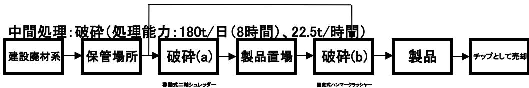
\* 建設廃材系の木くずは、一時保管場所に移し、破碎する。製品は、有価にする。
