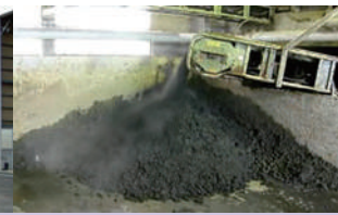
汚泥脱水処理施設：中間処理後、セメントの原料等として資源化
