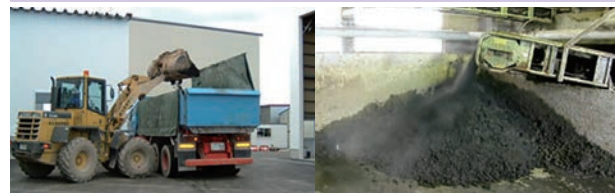
汚泥脱水処理施設：中間処理後、セメントの原料等として資源化
