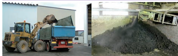
汚泥脱水処理施設：中間処理後、セメントの原料等として資源化
